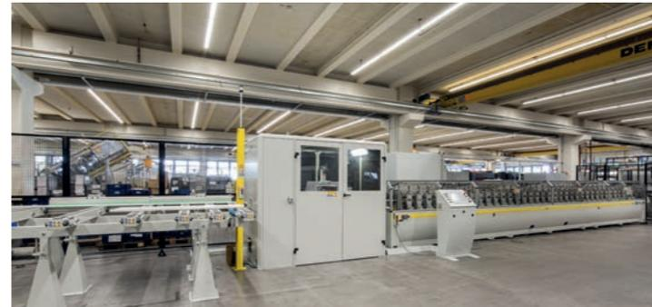
Mit den Rollieranlagen fertigt die RIDI Group unterschiedliche Blechteile aus vorbeschichtetem Material, z. B. für Tragschienen oder Geräteträger. Die Anlagen bestehen aus bis zu 36 Stationen mit jeweils mehreren Rollen. Durch diese Stationen wird das Blech durchgeschoben und nach Vorgabe geformt. Die Rollieranlagen besitzen ebenfalls eine Stanzvorrichtung, mit der eine vollautomatische Fertigung der Einzelteile realisiert wird.
