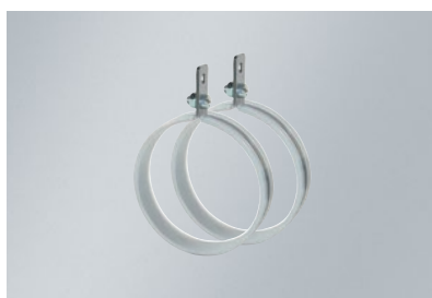
> Colliers de fixation pour LUZERN 38 LED, Ø 38 mm, en acier inoxydable/matière synthétique transparente, pour suspension, Code art. 538 319
