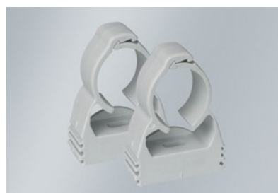
> Colliers de fixation résistants au chlore (version piscines), pour LUZERN 38 LED, en matière synthétique grise, Ø 38 mm, pour montage au plafond ou au mur (la paire), Code art. 538 003
